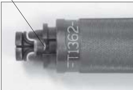
Figure 3 – O-ring & B-ring Loaded Into Tool Abbildung 3 – In das Werkzeug geladener O-Ring und Stützring
